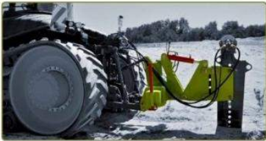
Funktionserprobung des Verlegesystems für Agrarflächenkollektoren
